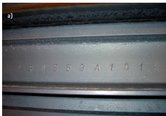
a) Beispiel einer Markierung auf Eisenbahnschienen, b) Nadeldruck auf einer Turbinenschaufel, Schriftgröße 1 mm
