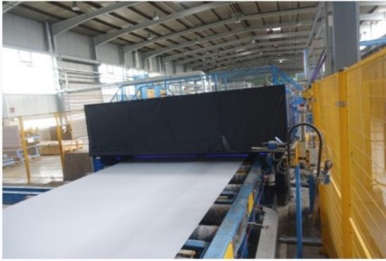
Die blaue Laserlinie zeigt die Position, an der die Blechoberfläche im Durchlauf abgetastet wird. Risse, Einwalzungen, Schalen und Dellen werden so erkannt und exakt vermessen.
